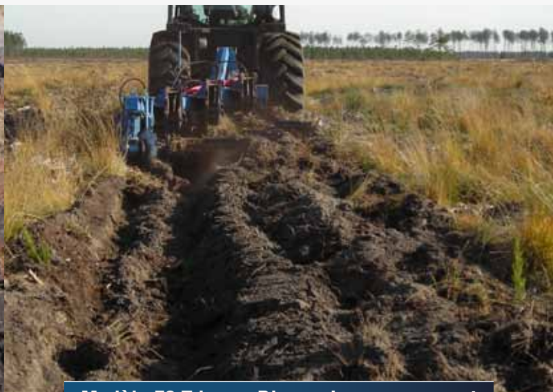
Modèle F2 Trisoc + Disque de recouvrement pour casser la cale de labour
