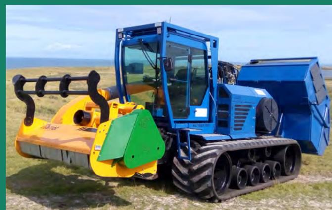
Broyeur BIOSYLVA, c'est un seul passage et à la vitesse habituelle. Il est capable de couper et envoyer l'herbe et les broussailles (jusqu'à 10 cm de diamètre) vers un container, pour les évacuer du terrain. Avec ce type d'application SERRAT veut contribuer à l'entretien des espaces verts et surtout des zones marécageuses. En exportant les restes vers une remorque ou une benne, pour son utilisation comme compost ou gazéification.
