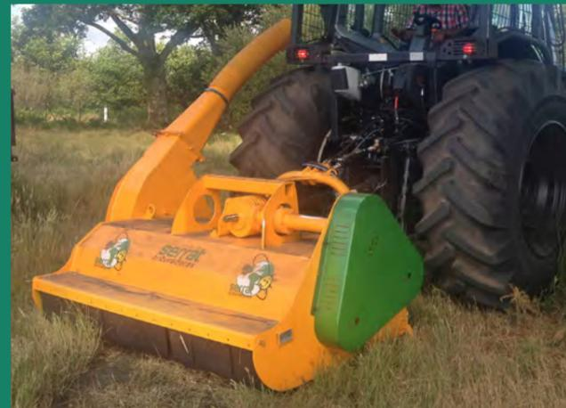
Le broyeur-récupérateur BIOGREEN permet, en un seul passage et à une vitesse constante, de couper, broyer et lancer la matière dans une remorque ou zone de stockage afin de l'évacuer du chantier.
