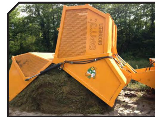
Protection anti fil de fer pour les roulements du rotor
